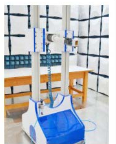
■ 高频俯仰天线塔
