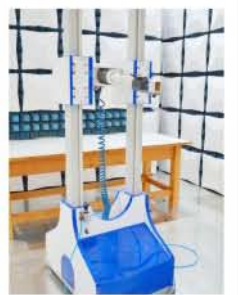
■ 高频俯仰天线塔
