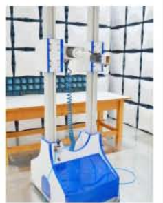
■ 高频俯仰天线塔
