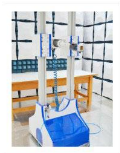
■ 高频俯仰天线塔
