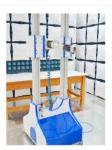
■ 高频俯仰天线塔
