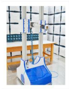
■ 高频俯仰天线塔
