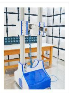
■ 高频俯仰天线塔
