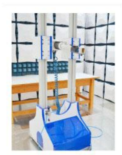
■ 高频俯仰天线塔
